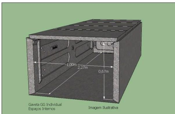
Essas carneiras podem ser sobrepostas porque possuem um encaixe que possibilita a sobreposição sem bloqueio das tampas das gavetas que ficam embaixo. Dessa maneira sempre haverá acesso da gaveta de cima para a de baixo, sem danos a estrutura da mesma, conforme figura abaixo:
